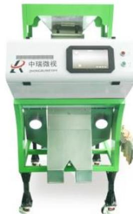
*Figura 1.2 Máquina separadora de maíz.*
