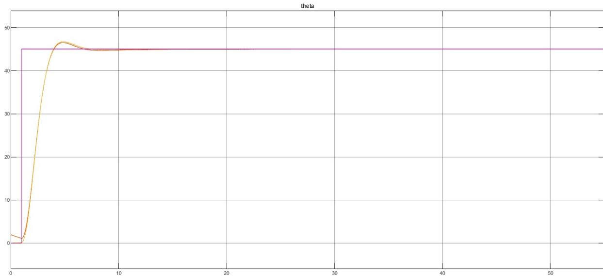
Figure 6: Estimación del estado del sistema utilizando LQG.
