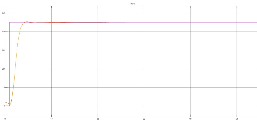
Figura 5: Estimación del estado del sistema utilizando LQE.
