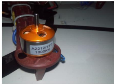
Figura 5: Montaje final de los motores en el chasis
