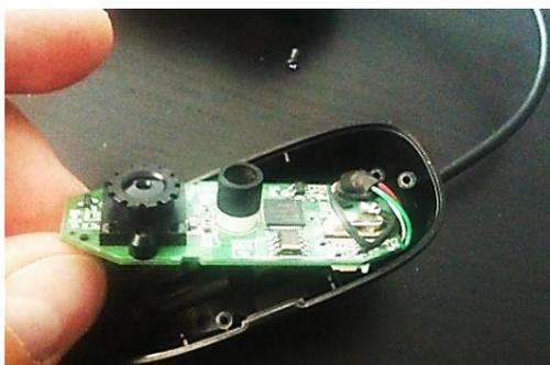
Figura 2. Circuito físico de la cámara Logitech C270
