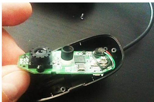
Figura 2. Circuito físico de la cámara Logitech C270
