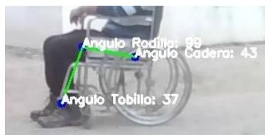
Figure 6: Prueba 8: detección correcta en el límite angular, con rodilla en 99° (cadera 43°, tobillo 37°).
