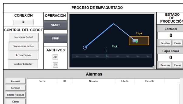
(b) Pantalla principal del proceso de empaquetado con contadores y panel de alarmas.
